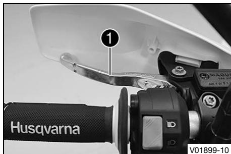
La maneta del embrague 1 se encuentra en el lado izquierdo del manillar. El embrague tiene accionamiento hidráulico y se reajusta automáticamente.
