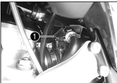
La posición de ralentí en el cuerpo de la válvula de mariposa influye considerablemente en la capacidad de arranque del motor, la estabilidad del régimen de ralentí y la respuesta al acelerar.
