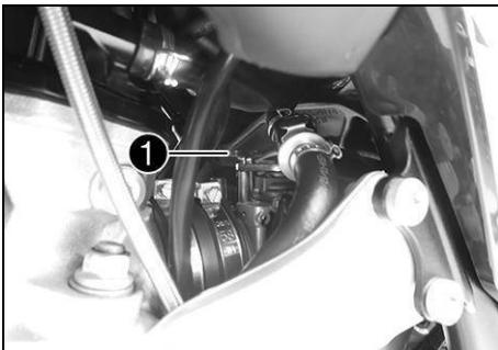
El ajuste del régimen de ralentí en el cuerpo de aceleración influye considerablemente en el comportamiento de arranque del motor, en la estabilidad del régimen de ralentí y en la respuesta al acelerar.
