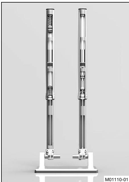
En la horquilla **WP XACT** se utiliza una suspensión neumática. En este sistema, la suspensión actúa en la botella izquierda de la horquilla y la amortiguación actúa en la botella derecha de la horquilla.
