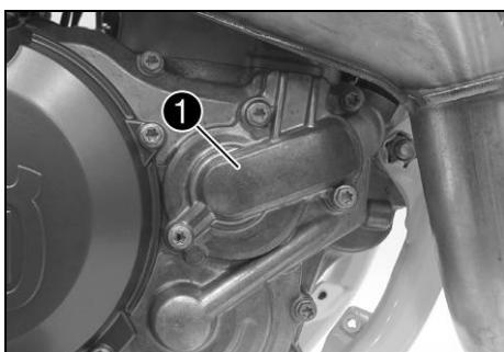
La bomba del agua 1 en el motor asegura una circulación forzada del líquido refrigerante.
