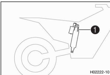
El número de artículo del amortiguador **1** está grabado en la parte superior del amortiguador, por encima del anillo de ajuste, mirando hacia el motor.
