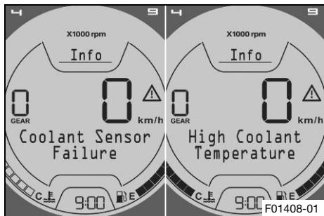
**Coolant Sensor Failure** aparece en el display cuando el sensor de temperatura del líquido refrigerante tiene un fallo.
