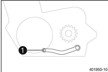
El pedal de cambio ① está instalado a la izquierda del motor.
