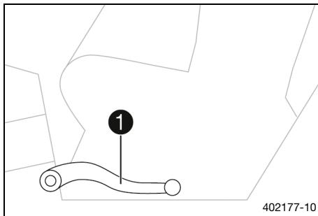
El pedal del freno ① se encuentra delante del reposapiés del lado derecho.
