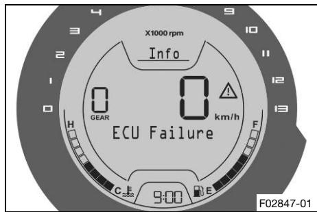
**ECU Failure** aparece en el display cuando la unidad de mando del motor notifica una anomalía de funcionamiento.
