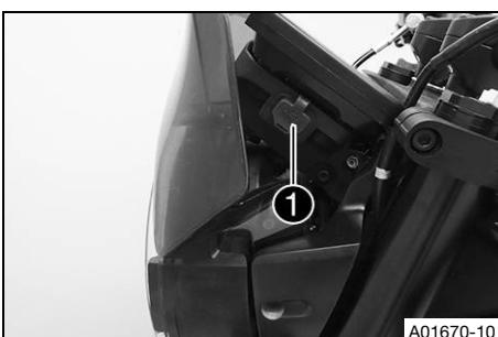
El conector USB 1 para la alimentación de tensión de dispositivos externos se encuentra en la parte izquierda del soporte de la cubierta.
