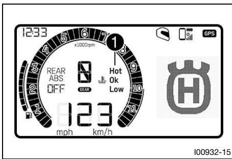
La temperatura del líquido refrigerante se indica con un símbolo 1. En función de la temperatura, el símbolo cambia entre **LOW**, **OK** y **HOT**.
