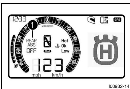
El modo de ABS ajustado se muestra en la zona 1 de la pantalla digital.
