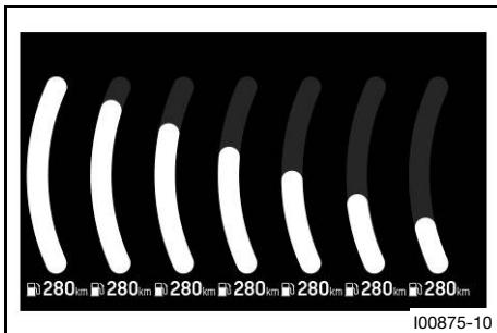
El indicador del nivel de combustible está compuesto por el indicador de autonomía y una barra. Cuanta más llena esté la barra, mayor será el nivel de combustible en el depósito de combustible.
