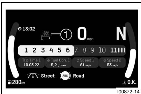
El estado de la calefacción de las empuñaduras se muestra en la zona **1** del display.
