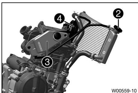
La refrigeración depende de la corriente de aire y de un ventilador del radiador (4) que se enciende a altas temperaturas.
