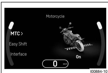
El control de tracción de la motocicleta (**MTC**) (opcional) reduce el par motor en caso de pérdida de tracción en la rueda trasera. En función del modo de conducción (pág. 123), con el control de tracción activado se permite más o menos derrapaje.
