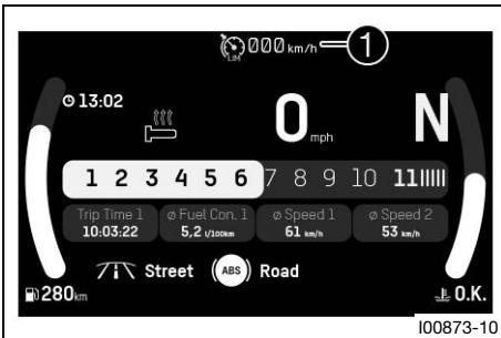
El estado de servicio del limitador de velocidad activado se muestra en la zona 1 del display.
