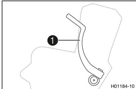
La palanca del pedal de arranque 1 se encuentra en el lado derecho del motor.
