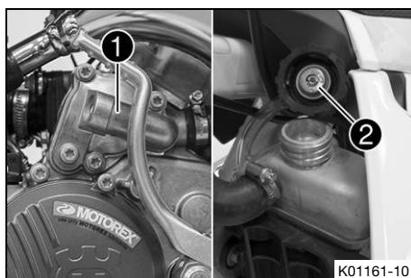
La bomba del agua 1 en el motor asegura una circulación forzada del líquido refrigerante.
