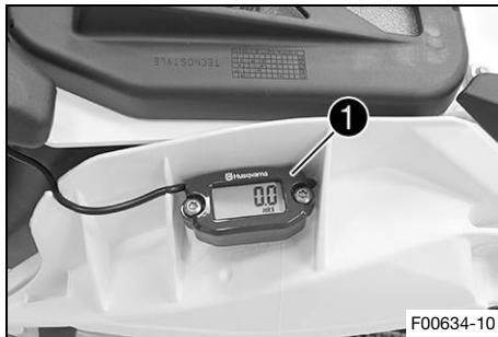
El contador de horas de servicio 1 está situado en la parte trasera, debajo del carenado lateral izquierdo.
