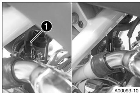
La palanca de arranque en frío 1 se encuentra en el lado derecho del carburador.
