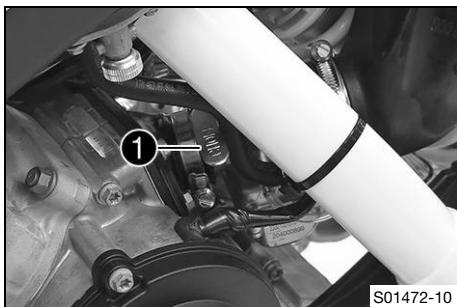
La palanca de arranque en frío 1 se encuentra en el lado izquierdo del carburador.
