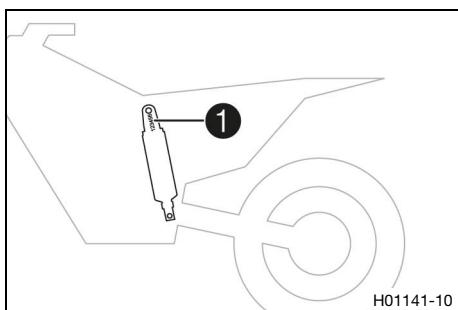
El número de artículo del amortiguador **1** está grabado en la parte superior del amortiguador por encima del anillo de ajuste, mirando hacia la izquierda.
