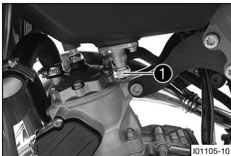
Con el mango (1) del grifo de la gasolina se abre y se cierra la alimentación de combustible al carburador.
