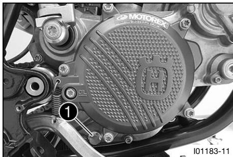
Tapón roscado de vaciado del motor con imán
