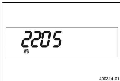
Después del control de funcionamiento del display, se muestra el perímetro de la rueda **WS** (wheel size).
