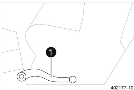
El pedal del freno 1 se encuentra delante del reposapiés del lado derecho.
