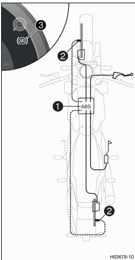
El módulo del ABS 1, compuesto por una unidad hidráulica, una centralita electrónica del ABS y una bomba de recirculación, está instalado debajo del depósito de combustible. Hay un sensor de número de revoluciones de la rueda 2 tanto en la rueda delantera como en la trasera.
