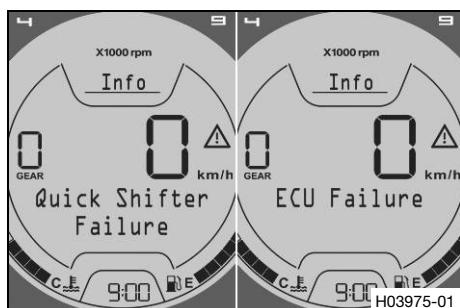
**Quick Shifter Failure** aparece en el display cuando Easy Shift tiene un fallo.
