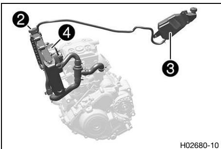
La refrigeración depende de la corriente de aire y de un ventilador del radiador 4 que se enciende a altas temperaturas. Cuanto menor sea la velocidad, menor es la acción refrigerante. La suciedad en los nervios del radiador reduce asimismo la acción refrigerante.
