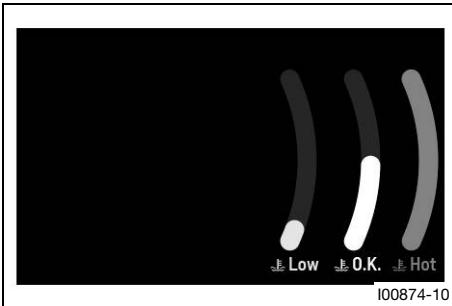
La temperatura del líquido refrigerante se indica con un símbolo. En función de la temperatura, el símbolo cambia entre **LOW**, **OK** y **HOT**.
